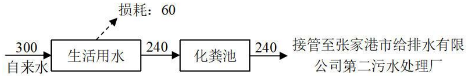
图 2-1 本项目水量平衡图 单位: t/a
