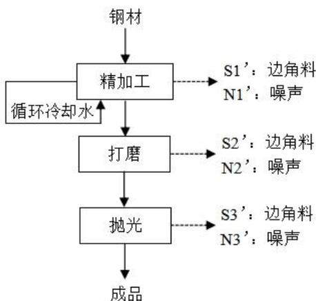
图 2-3 原有项目生产工艺及产污环节流程图
