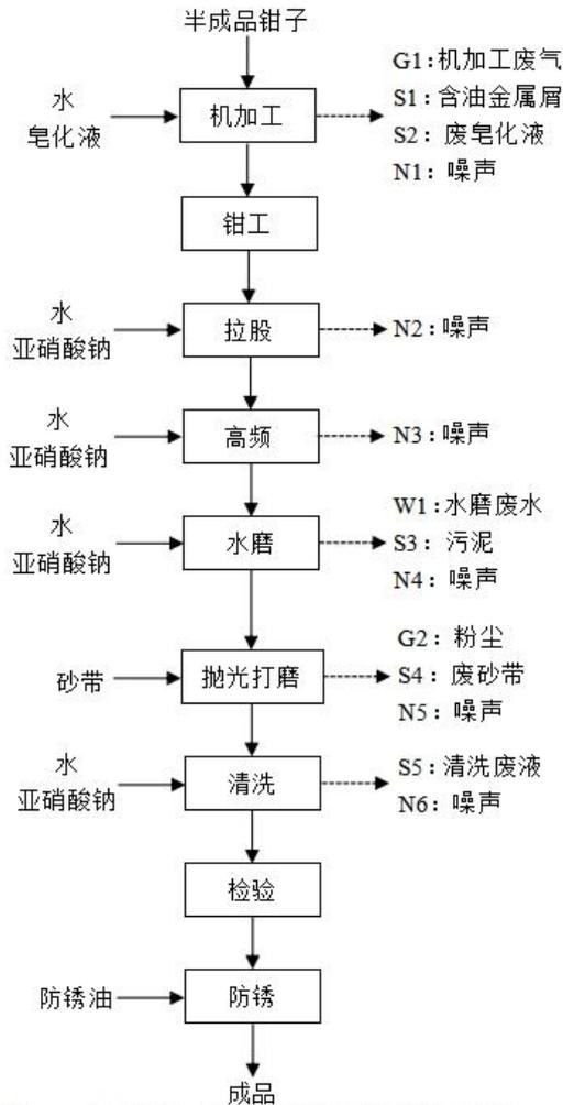
图 2-2 本项目生产工艺及产污环节流程图
