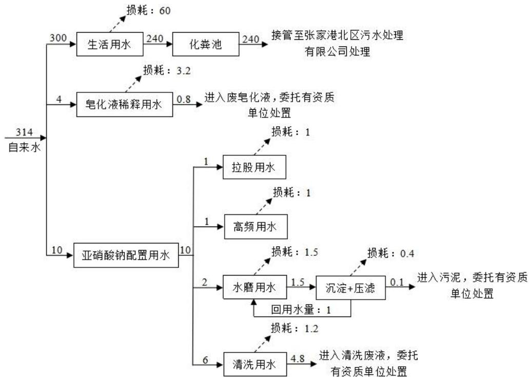
图 2-1 本项目水量平衡图 单位：t/a
